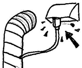
水道管の凍結防止用に電熱線が巻いてある場合、凍結の心配のない春から秋までコンセントを抜いておくと電気代を節約できます。但し、冬に入る前に再び繋ぐことを忘れないでください。温度による作動切替が付いているタイプなら季節毎のコンセントの抜き差しは必要ありません。また付いていない場合でも、2,000円～程の料金で取付けることが出来ます。
